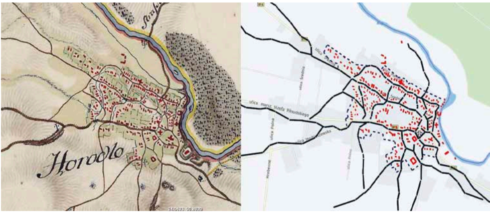
Il. 3. Plan Horodła z siatką ulic z początków XIX w. i plan dzisiejszy. Linia przerywaną zaznaczono granice zwartej zabudowy miejskiej z początku XIX w. Kolorem czerwonym oznaczono rozmieszczenie budynków na początku XIX w. Sporządzono na podstawie tzw. Mapy Miega, https://maps.arcanum.com (dostęp: 28.12.2021)
