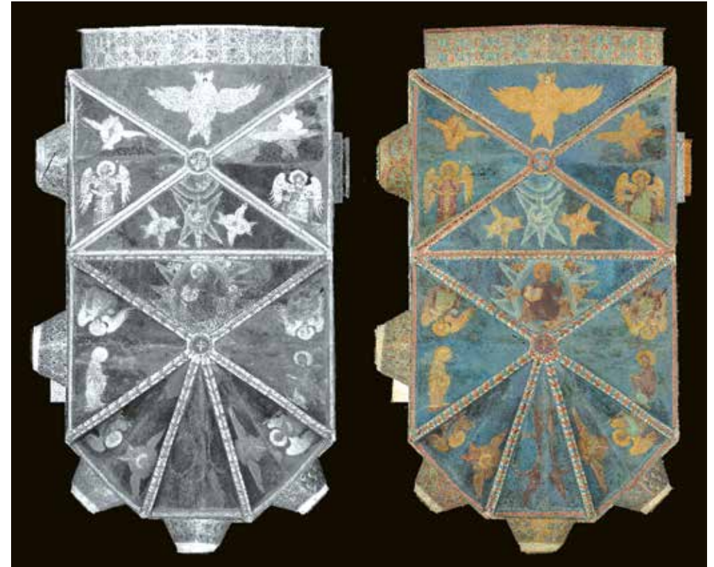
Rys. 2. Strona lewa: chmura punktów ze skanera laserowego, strona prawa: chmura punktów z opracowania fotogrametrycznego
