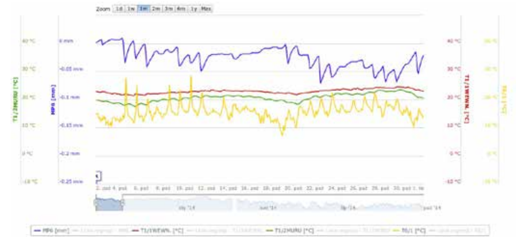
Rys. 9. Ilustracja ciągłych zapisów temperatury wewnętrznej (kolor czerwony) i temperatury zewnętrznej (kolor zielony) na tle zapisu zmian rozwarcia rysy w pierwszym MP6 punkcie pomiarowym
