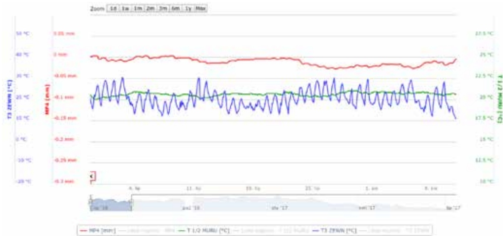
Rys. 13. Ilustracja zapisów zmian temperatury i skali zmian rozwarcia rysy na II etapie pomiarów w punkcie pomiarowym MP4
