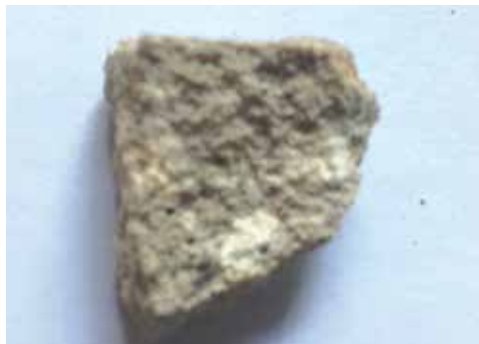
Fot. 4. Próbk nr 3A - tynk z zamurowanej wnęki
