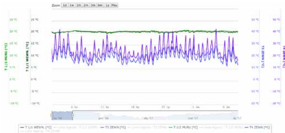
Rys. 14. Ilustracja zapisów temperatury zewnętrznych i wewnętrznych kaplicy na II etapie pomiarów
