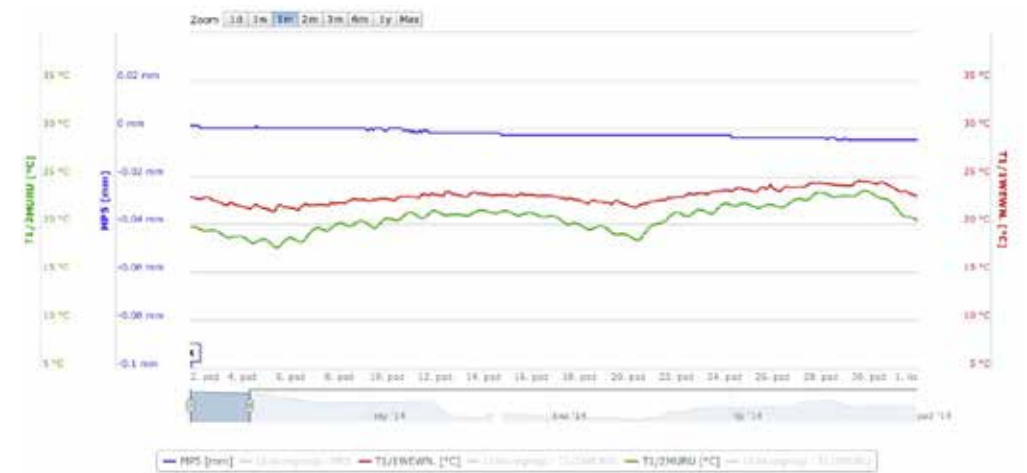
Rys. 8. Ilustracja ciągłych zapisów temperatury wewnętrznej (kolor czerwony) i temperatury zewnętrznej (kolor zielony) na tle zapisu zmian rozwarcia rysy w pierwszym MP5 punkcie pomiarowym
