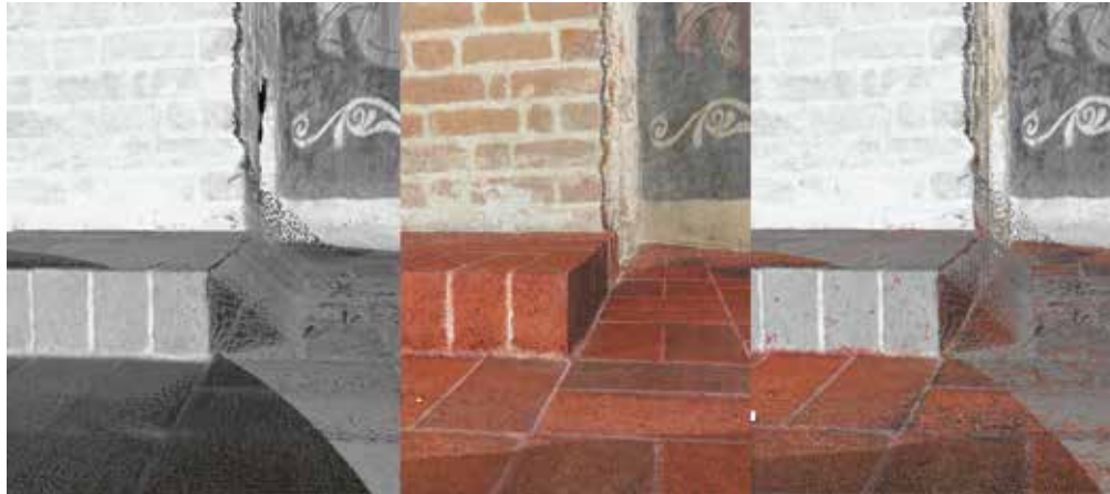
Rys. 3. Błędy chmury punktów pochodzącej ze skanera laserowego. Strona lewa: chmura punktów ze skanera laserowego, środek: chmura punktów z opracowania fotogrametrycznego, strona prawa: złożenie chmur punktów
