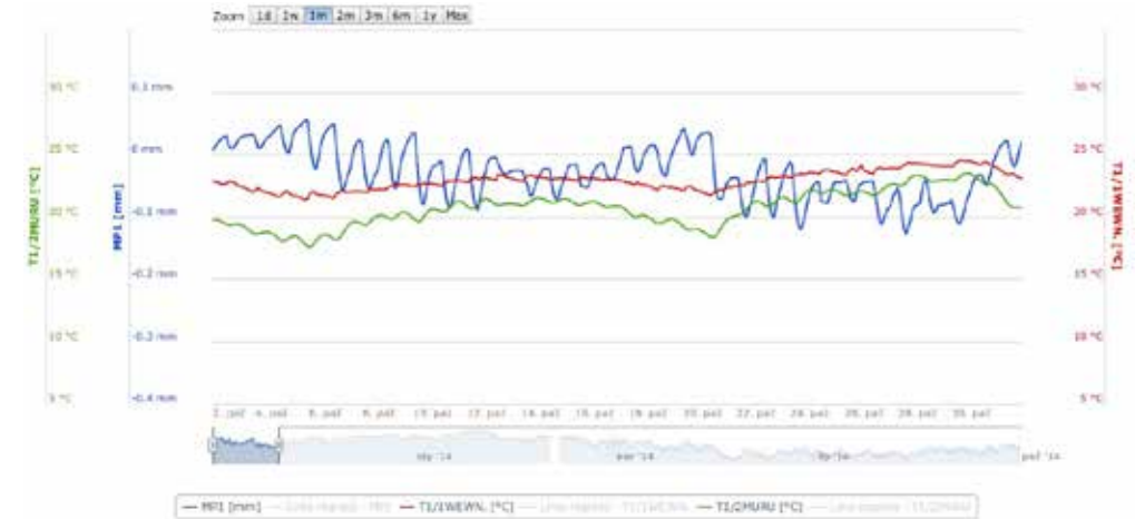
Rys. 4. Ilustracja ciągłych zapisów temperatury wewnętrznej (kolor czerwony) i temperatury zewnętrznej (kolor zielony) na tle zapisu zmian rozwarcia rysy w pierwszym MP1 punkcie pomiarowym
