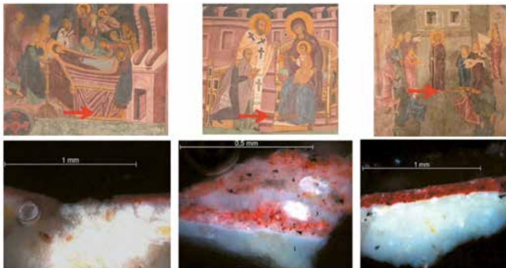
Ilustr. 1. Zdjęcia mikroskopowe przekrojów stratygraficznych wykonanych z próbek pobranych z czerwonych obszarów z trzech różnych scen: Zaśnięcie Matki Boskiej , Scena fundacyjna oraz Naigrawanie
