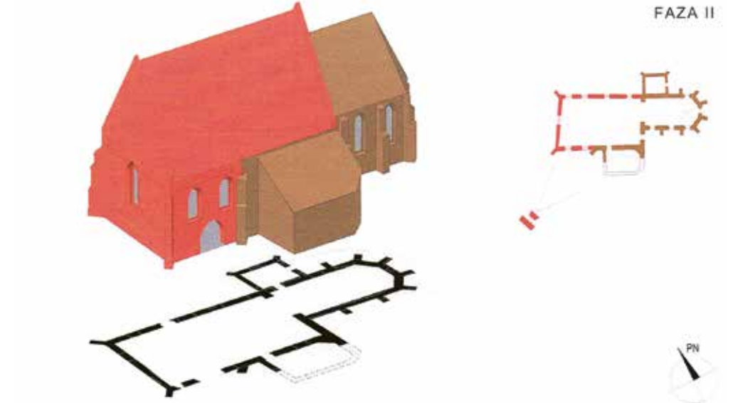
Ilustr. 15. Rekonstrukcja rzutu i bryły kościoła z fazy drugiej. Widok od strony południowo-zachodniej, rys. S. Więcek
