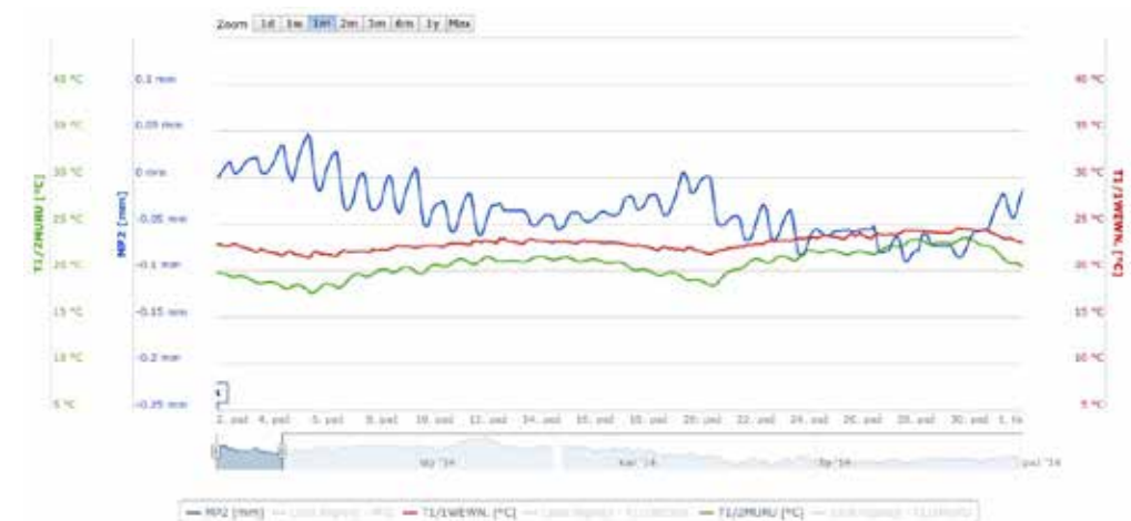
Rys. 5. Ilustracja ciągłych zapisów temperatury wewnętrznej (kolor czerwony) i temperatury zewnętrznej (kolor zielony) na tle zapisu zmian rozwarcia rysy w pierwszym MP2 punkcie pomiarowym
