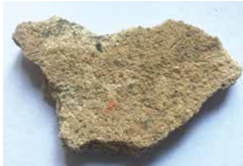
Fot. 2. Próbk nr 1 - tynk z glifu okiennego
