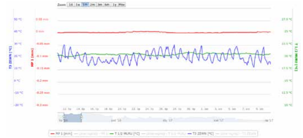
Rys. 11. Ilustracja zapisów zmian temperatury i skali zmian rozwarcia rysy na II etapie pomiarów w punkcie pomiarowym MP2
