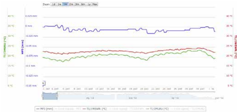
Rys. 6. Ilustracja ciągłych zapisów temperatury wewnętrznej (kolor czerwony) i temperatury zewnętrznej (kolor zielony) na tle zapisu zmian rozwarcia rysy w pierwszym MP3 punkcie pomiarowym
