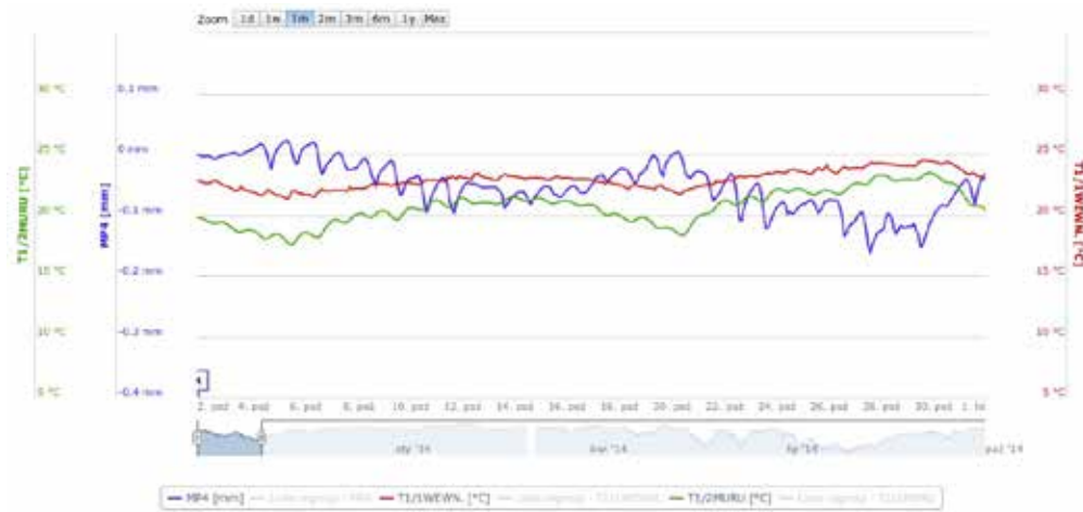
Rys. 7. Ilustracja ciągłych zapisów temperatury wewnętrznej (kolor czerwony) i temperatury zewnętrznej (kolor zielony) na tle zapisu zmian rozwarcia rysy w pierwszym MP4 punkcie pomiarowym
