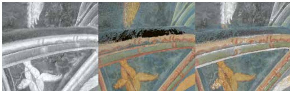
Rys. 4. Błędy chmury punktów pochodzącej z opracowania fotogrametrycznego. Strona lewa: chmura punktów ze skanera laserowego, środek: chmura punktów z opracowania fotogrametrycznego, strona prawa: złożenie chmur punktów
