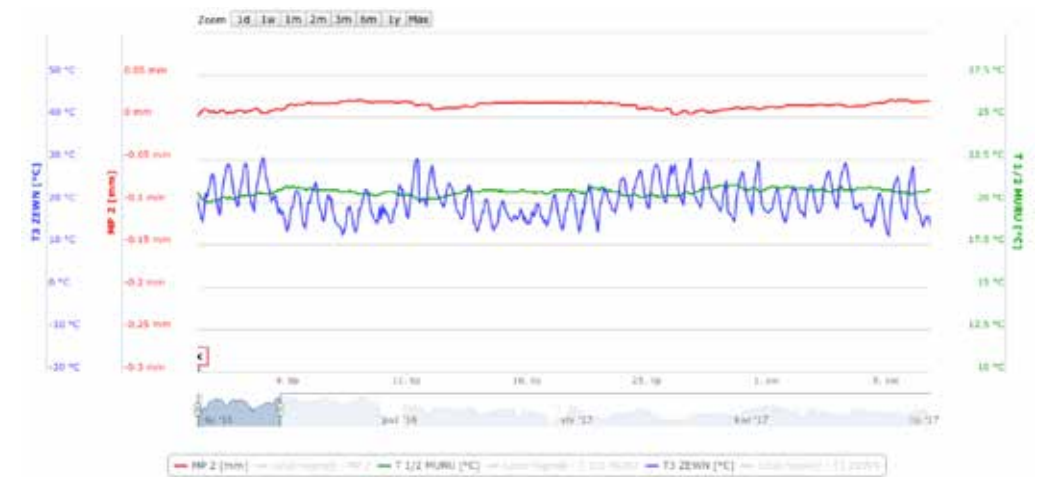
Rys. 12. Ilustracja zapisów zmian temperatury i skali zmian rozwarcia rysy na II etapie pomiarów w punkcie pomiarowym MP2
